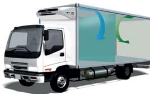
Grazie al moderno sistema di controllo Truck Smart Reefer 2 (TSR-2) e al nuovissimo software di controllo, un operatore della Serie T Spectrum può scegliere, tra un'ampia gamma di funzioni programmabili, quelle necessarie per regolare con precisione le prestazioni dell'unità in base alle esigenze del carico, bilanciando la gestione delle temperature e il risparmio di carburante.
